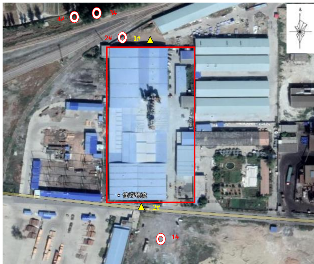
图 4 无组织废气、噪声监测布点示意图
